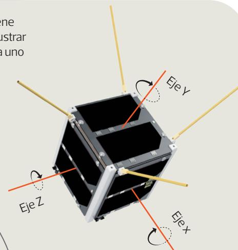
El magnetómetro en el CubeSat mide la dirección de las líneas del campo magnético de la Tierra.
