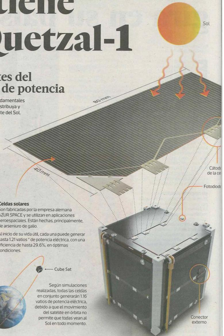
Según simulaciones realizadas, todas las celdas en conjunto generarán 1.16 vatios de potencia eléctrica, debido a que el movimiento del satélite en órbita no permite que todas vean al Sol en todo momento.
